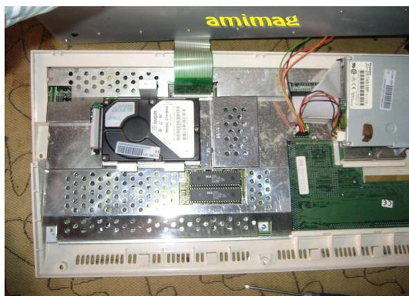
Escom, c'est un Seagate qui y est installé. Le disque dur en question est fixé dans un « berceau », il faut donc déloger le tout ensemble. Pour cela, il suffit de
